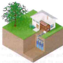
Pompe à chaleur sur corbeilles géothermiques
