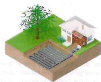
Pompe à chaleur sur capteurs enterrés horizontaux
